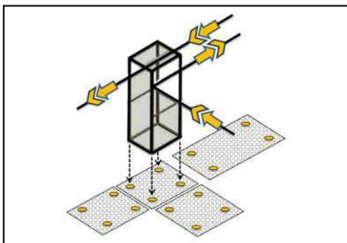
Все оборудование ставится на пол и устанавливается на раму, что значительно уменьшает затраты на строительство и упрощает установку.
