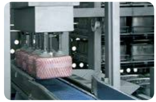
3. Démoulage automatique Автоматическое извлечение из форм
