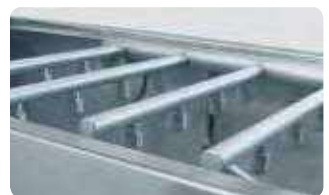
58 buses inox (démontables) 58 съемных форсунок
