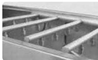
63 buses inox (démontables) 63 съемных форсунок
