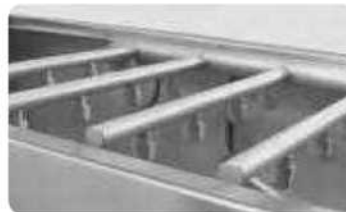
63 buses inox (démontables) 63 съёмных форсунок
