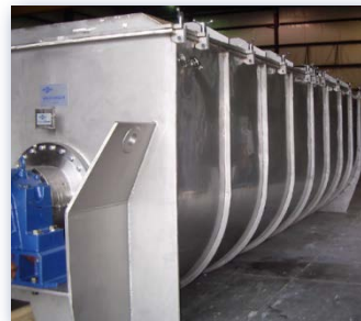
Варочный котел непрерывного действия для пищевых ингредиентов, утвержденный Министерством сельского хозяйства США
