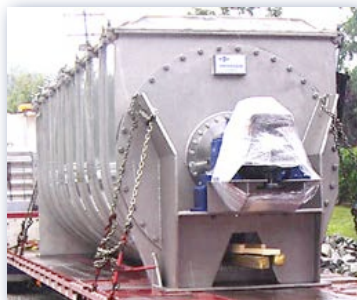
Варочный котел непрерывного действия для пищевых ингредиентов, утвержденный Министерством сельского хозяйства США
