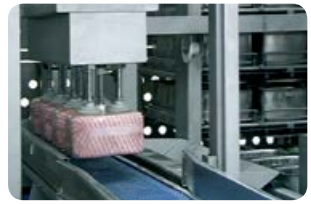
3. Démoulage automatique Автоматическое извлечение из форм
